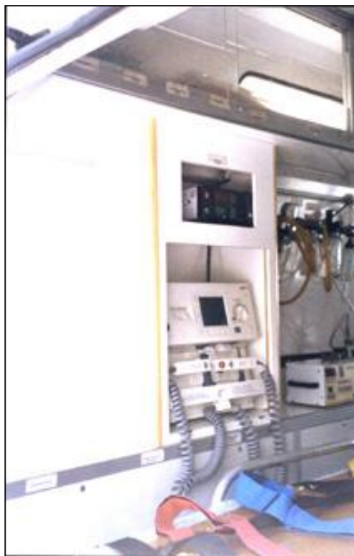
Figura 6 – Disposição dos equipamentos na lateral esquerda da cabine posterior da UTI Móvel, vista pela porta traseira
