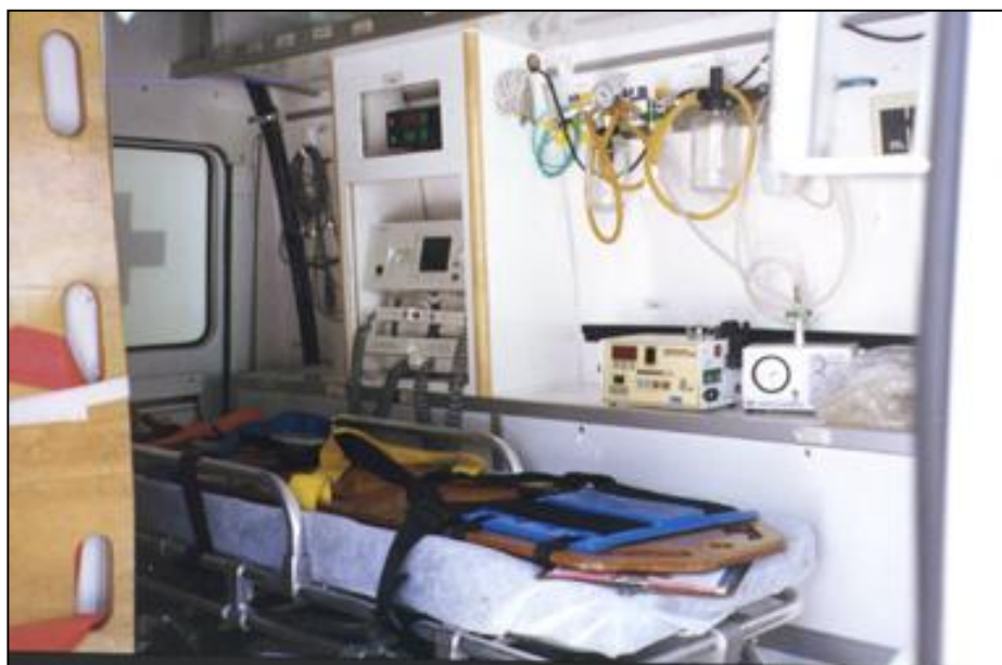
Figura 7 – Disposição dos equipamentos na lateral esquerda da cabine posterior da UTI Móvel, vista pela porta lateral
