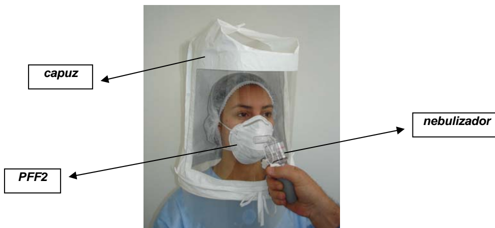
Figura 7: Ensaio de Vedação Facial com sacarina ou Bitrex
