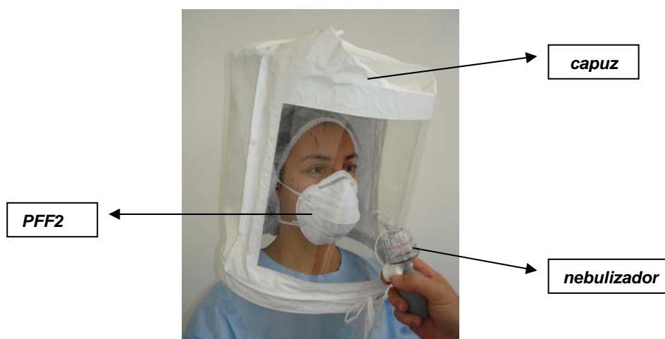
Figura 20: Capuz e nebulizador utilizados nos ensaios de vedação qualitativo com névoa de sacarina ou bitrex
