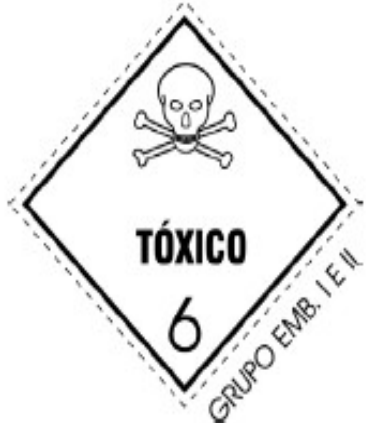
Grupos de embalagem I e II Símbolo – cor preta Fundo – cor branca Figura A.14 - Subclasse 6.1
