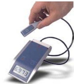
Figura 9 : Foto de um determinado tipo de dosímetro de bolso ou caneta dosimétrica.
