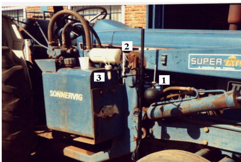
Figura 1- Árvore de Termômetros onde: 1- Termômetro de Globo; 2- Termômetro de Bulbo Seco e 3- Termômetro de Bulbo Úmido.
