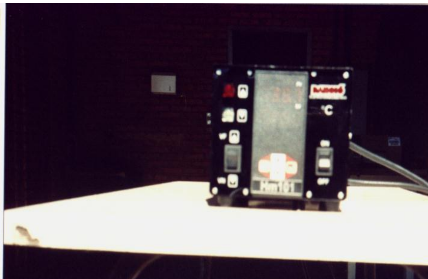
Figura 2- Controlador de Temperatura HM 101 - Cortesia Dangió Eletrotermometria
