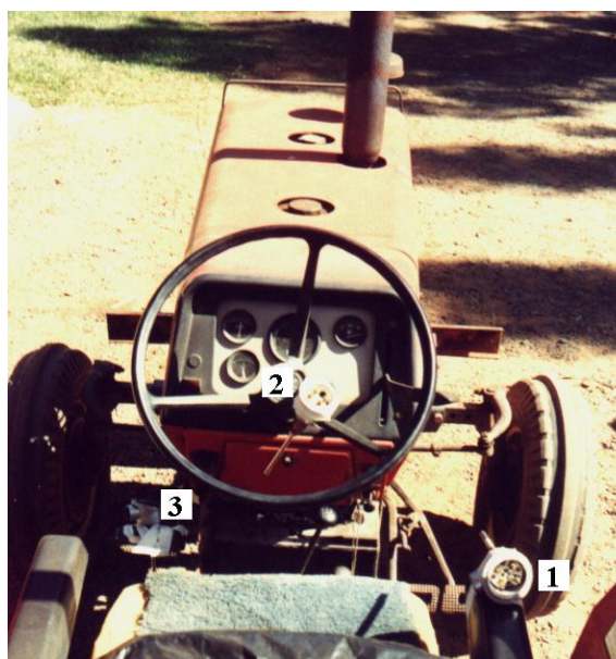
Figura 3 - Vista interna do posto de operação de um trator com os três sensores.
