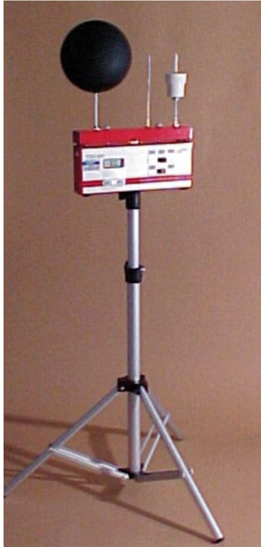
Figura 2 – Conjunto para medição do índice IBUTG
