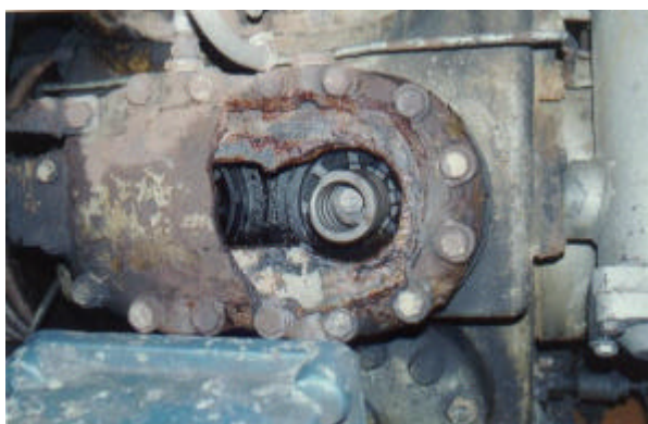
Figuras 10 e 11 – Tampa do compressor rompida
